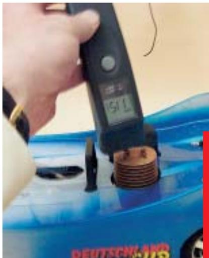
**Messen der Motortemperatur mit einem Infrarot-Thermometer: 115 °C, noch im grünen Bereich.**
