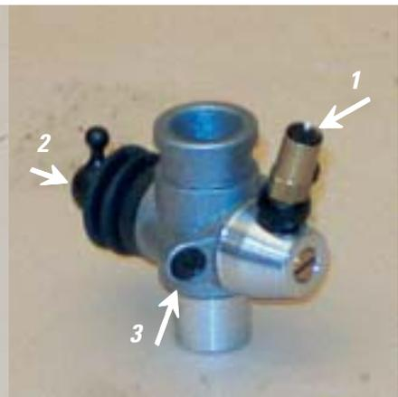
**Einstellelemente bei einem Novarossi-Vergaser:**
